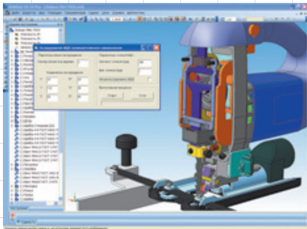
Модель электролобзика ПМ4-700Э (разработчики — Анатолий Охота, Илья Дегтярев) и приложение для расчета его МЦХ
