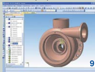
Вырезаем вращением внутреннюю полость в насосе
