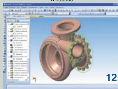
Вырезаем выдавливанием лишнюю часть фланцев
