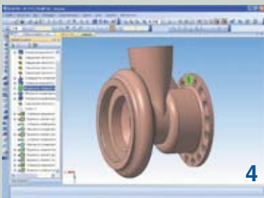
Вырезаем отверстие под болт и делаем концентрический массив
