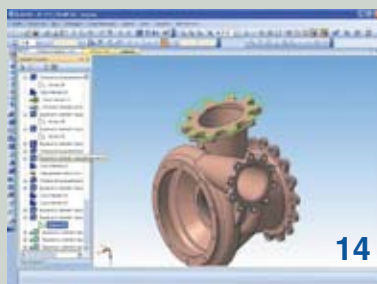
Вырезаем выдавливанием лишнее с фланца входа
