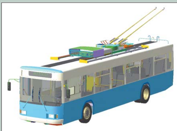
Лучший коллективный проект. Вологодский государственный технический университет. Троллейбус городской пассажирский с низким уровнем пола
